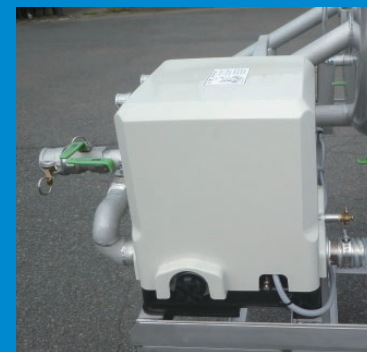
●電動ポンプ 加圧ポンプ搭載の場合は圧送給水との併用が可能です。
