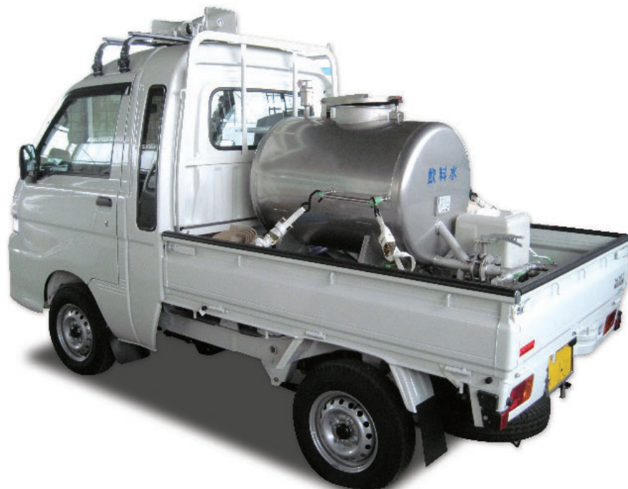
軽トラッククラス積載用タンク 加圧ポンプ搭載仕様
